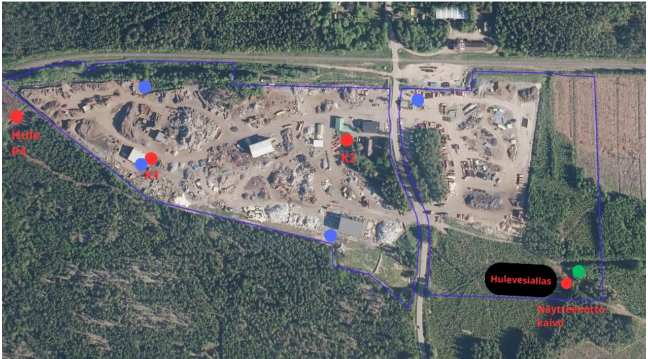
Kuva 9. Tarkkailupisteet. Aiemmat laitoksen alapuoliset tarkkailupisteet HuleP1 ja HuleP2 on korvattu hulevesien viivytysaltaan valmistumisen jälkeen tarkkailupisteellä näytteenottokaivossa (Euro NOK PE D400). HuleP4 edustaa laitoksen yläpuolista tarkkailupistettä. Pohjavesinäytteet otetaan tarkkailupisteistä K1 ja K2. Tihennetyn tarkkailujakson aikana (2022–2024) vesistövesinäytteet otettiin myös Luittilanjärvenojasta. Sammutusvesikaivot on merkitty sinisellä ja uusi louhittava kaivo vihreällä.
