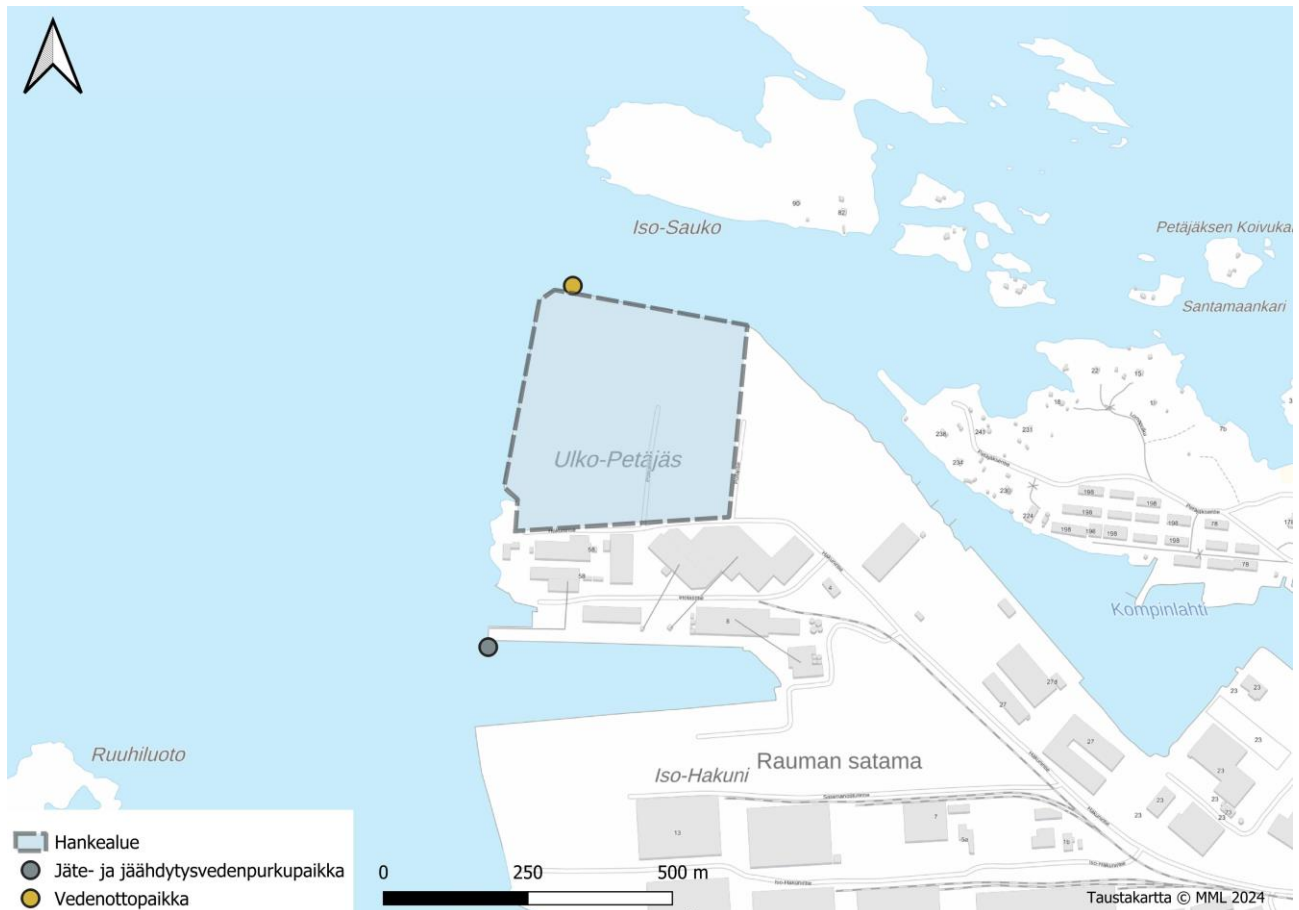
Kuva 2-5. Hankkeessa käytettävät vedenottopiste sekä puhdistettujen jätevesien ja jäähdytysveden purkupiste.
